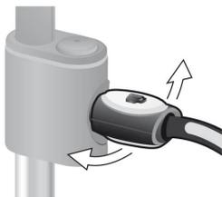
3. Tirer le mouseur lait (6) pour l'ouvrir. La machine se met à chauffer. De l'eau chaude s'écoule durant 40 s environ de l'embout du mouseur de lait (6).
