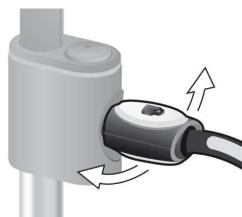
3. Trek aan de melkschuimer (6) om deze te openen. Het apparaat warmt op. Er loopt gedurende ca. 40 seconden warm water uit de uitloop van de melkschuimer (6).
