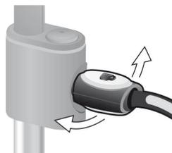
3. Потяните за насадку для приготовления молочной пены (6), чтобы открыть ее. Прибор нагревается. Из выпускной трубки насадки для приготовления молочной пены (6) примерно сорок секунд будет течь горячая вода.
